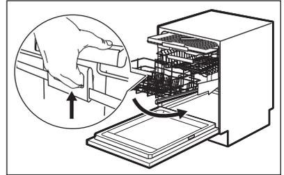
Drücken Sie nach dem Entriegeln den Korb nach unten. Der Mechanismus kehrt in die Standardposition auf der unteren Ebene zurück.
