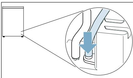
6. Tryck fast avloppsslagen i maskinens slanghållare.
