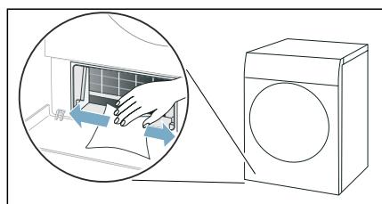
**Anvisning:** Se till så att du inte skadar den fritagda värmeväxlaren.
