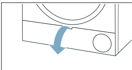
3. Lossa spaken till värmeväxlarskyddet.
