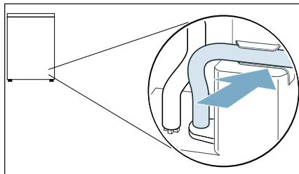
**Anvisning:** Se till så att du inte veckar avloppsslagen.
