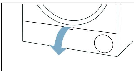
3. Lossa spaken till värmeväxlarskyddet.
