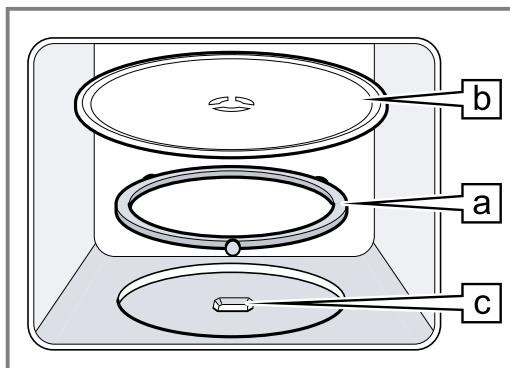
2. Snäpp fast vridtallriken **b** på drivfästet **c** mitt på ugnsbotten.
