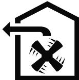
Poistoilmaa ei saa johtaa hormiin, jota käytetään kaasua tai muita polttoaineita polttavien laitteiden pakokaasun poistoon (tämä ei koske kiertoilmalaitteita).
