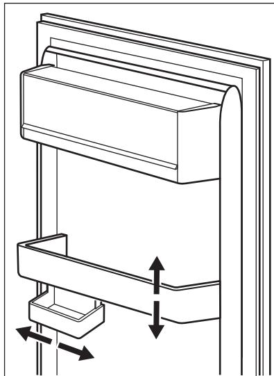
Tämä malli on varustettu muunneltavalla säilytyslaatikolla, jota voidaan siirtää sivuttain.
