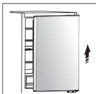
3. Lossa skruvarna som håller fast det mellersta gångjärnet och ta bort det. Ta sedan loss den nedre dörren. Och skruva loss gångjärnet på den nedre dörren.
